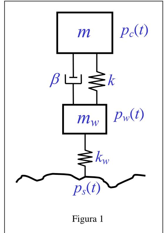
Ponendo  $x = [p_c \quad p_w \quad \dot{p}_c \quad \dot{p}_w]^T$ ,  $u = p_s$ ,  $y = p_c$ , si ottengono le seguenti equazioni di stato:
